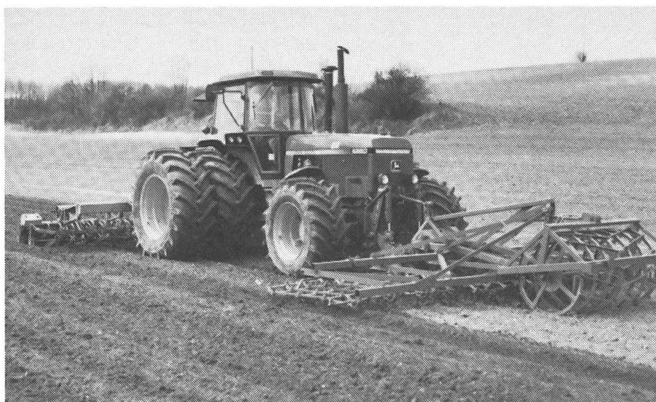
Roues extra-larges à l'avant, roues extra-larges à l'arrière. C'est le fin du fin pour, bien sûr, un investissement très important, limité aux reprises de sol.
