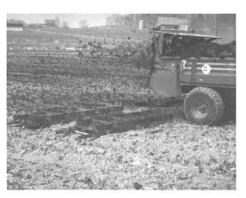
Fig. 3: Mesurage de l'exactitude de distribution
