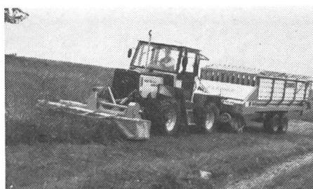
roues de mêmes dimensions, verrouillage des différentiels avec effet de verrouillage intégral sur les deux essieux, entraînement forcé sur les quatre roues sans embrayage patinant, marche synchrone des deux essieux et donc mêmes trajets pour les quatre roues, avec poids principal sur l'essieu avant.
