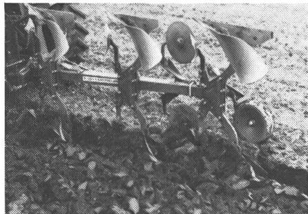
La largeur de raie des nouvelles charrues portées Kverneland avec système Variomat peut être réglée en continue, tout selon le modèle, hydrauliquement ou manuellement. D'où divers avantages:
