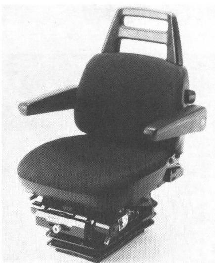
en tissu ou en PVC. Le dossier ainsi que les accoudoirs sont réglables. La suspension de la barre de torsion brevetée est ajustable aux poids des conducteurs de 50 à 120 kg.
