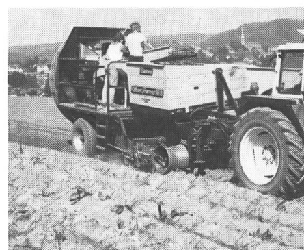
SAMRO Offset – une nouvelle arracheuse latérale pour pommes de terre. L'entraînement de la chaîne élévatrice et de nettoyage et de la table de triage est hydraulique et peut être réglé sans paliers.
