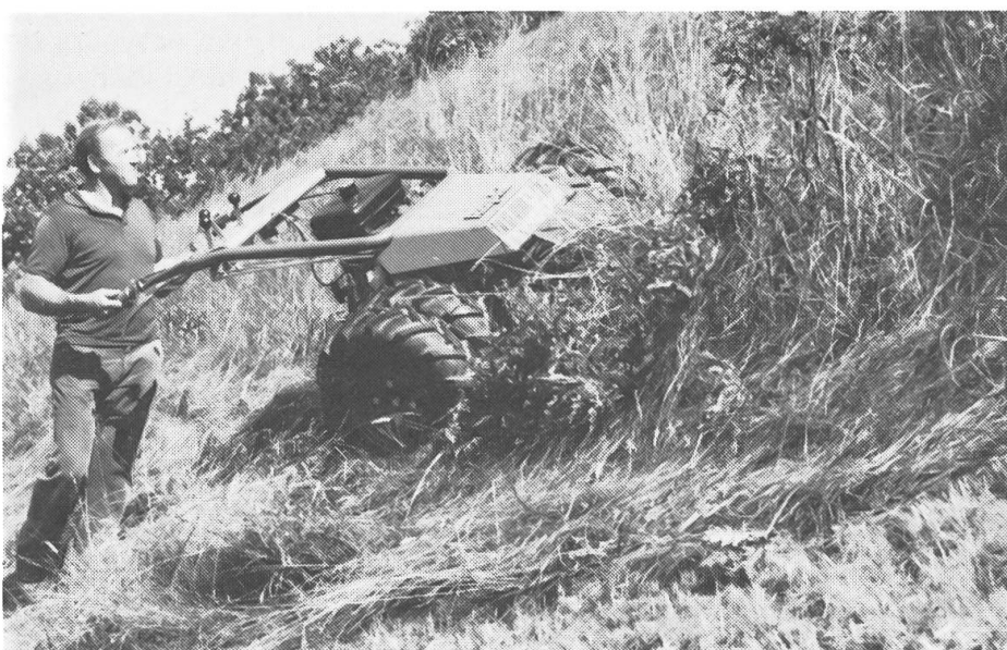
Le frein à roue unique fonctionne lorsque le guide de la faucheuse à large voie du Rapid 406 pivote ce qui réduit le besoin en force humaine lorsque le conducteur corrige la direction d'avancement.
