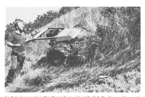
Le frein à roue unique fonctionne lorsque le guide de la faucheuse à large voie du Rapid 406 pivote ce qui réduit le besoin en force humaine lorsque le conducteur corrige la direction d'avancement.
