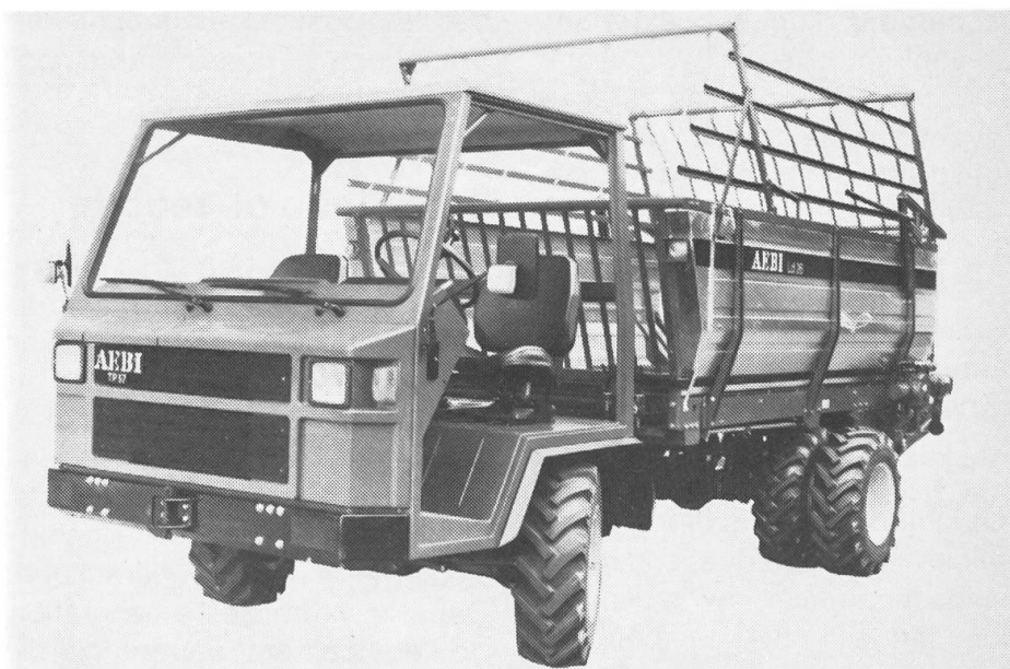
Un moteur Mercedes à 4 cylindres de 39 kW/53 CV offre au nouveau modèle AEBI TP 57 l'avancement silencieux désiré. L'engrenage dispose de 8 vitesses avant et de 4 vitesses arrière. La prise de force est couplable sous charge.
