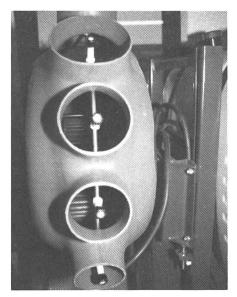
Fig. 8: La soufflerie radiale, mod. Hardi Combi présente un boîtier du côté droit, lequel peut être pivoté avec un système hydraulique. Cet appareil à grande portée est utilisés avant tout pour des pépinières ou des arbres très hauts.
