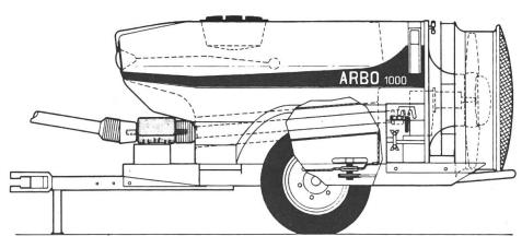
A droite: schéma du pulvérisateur traîné avec soufflerie axiale à deux paliers, brasseur à hélice mécanique, tamis de remplissage et échelle graduée flotteuse (mod. Berthoud).
