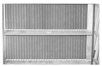
Fig. 10: Les mesurages de la répartition verticale des gouttes ont eu lieu sur le banc d'essai de la FAT avec des profils verticaux de séparation des gouttes. Mesurages:  $4.0 \times 0.8 \times 0.2$  m à raison de 12 domaines de hauteur allant de 0.3 m, 0.4 m jusqu'à 4 m de haut.
