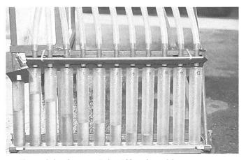
Fig. 11: Répartition verticale de la bouillie selon un réglage conventionnel des buses et des tôles de guidage (à gauche). A droite: essai de réglage selon les formes des arbres en diminuant de façon linéaire la surface des feuilles vers le haut de l'arbre.
