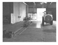
Fig. 6: La vitesse de l'air a été mesurée à l'aide de manomètres électroniques, et cela à six endroits de chaque côté de la souffleuse. Vitesse de parcours: 4,5 km/h: les anémomètres suivant sur un rail ont été dépassés.
