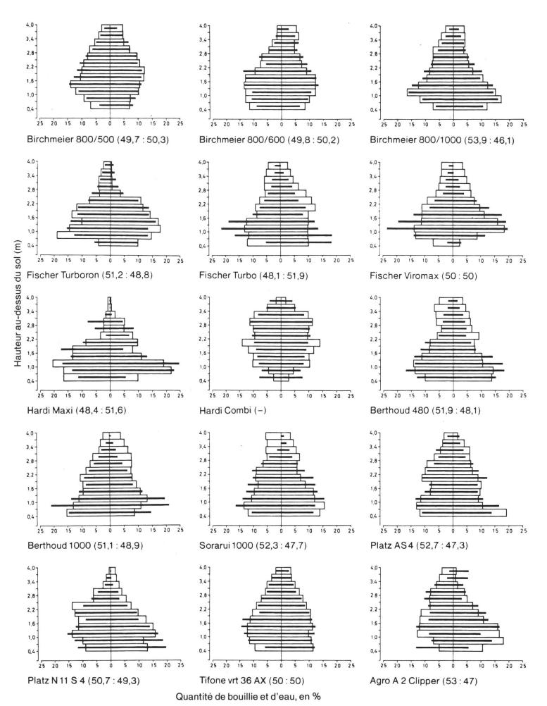
Fig. 12: Résultats de la répartition verticale de la bouillie du côté gauche et droit des pulvérisateurs (Hardi Combi: seulement côté droit).
