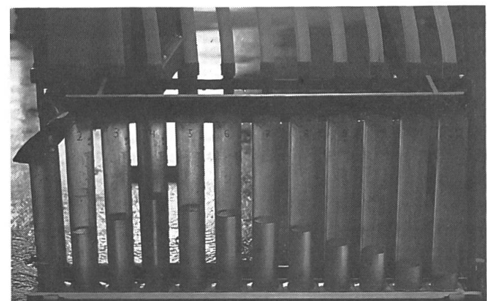
Fig. 11: Répartition verticale de la bouillie selon un réglage conventionnel des buses et des tôles de guidage (à gauche). À droite: essai de réglage selon les formes des arbres en diminuant de façon linéaire la surface des feuilles vers le haut de l'arbre.
