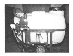
Fig. 1: A gauche: pulvérisateur porté, orifice de remplissage bien placée et échelle graduée (mod. Platz).
