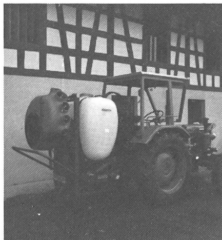
Fig. 8: La soufflerie radiale, mod. Hardi Combi présente un boîtier du côté droit, lequel peut être pivoté avec un système hydraulique. Cet appareil à grande portée est utilisé avant tout pour des pépinières ou des arbres très hauts.
