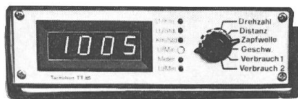
4: Les systèmes d'informations installés après-coup ne sont pas à même de reprendre des fonctions de guidage directement dans le système. Malgré tout, ils peuvent donner des indications utiles à l'agriculteur, en particulier sur les tracteurs de catégories moins puissantes (pulvérisation des plantes, épandage d'engrais etc.)
