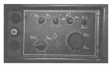
1: Tableau de bord d'un système de relevage électronique
