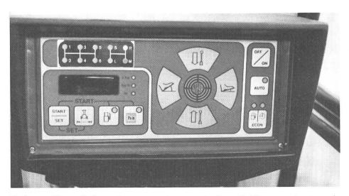
3: Le système d'informations permet au conducteur d'utiliser son tracteur de façon plus rentable. Le tableau de bord lui indique s'il doit changer de vitesse ou s'il doit diminuer ou augmenter ses tours/minute (gaz) par rapport à la performance horaire. Il voit également l'influence que cela peut avoir sur la consommation de carburant.
