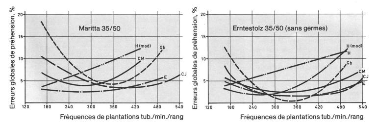
Fig. 3: Relation entre la performance de plantation (ou la fréquence de plantation) et l'exactitude de préhension pour des semences de (Maritta) avec ou sans germes (Erntestolz). CM = CRAMER MINOR G = GRUSE VL 16, a = sans vibrations, b = avec vibrations CJ = CRAMER JUNIOR SPECIAL H = HASSIA GLV, mod. = avec modifications de la part du fabricant E = EHO 442 S
