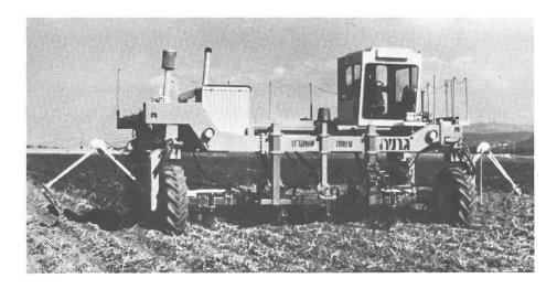
Israël a vu le développement d'un tracteur selon un concepte tout à fait nouveau. Le «tracteur FPU-Merhav» forme des traces d'une largeur de 6 m. Les outils pour le travail du sol ne sont pas attelés, mais montés dans l'espace entre l'essieu avant et l'essieu arrière. Le moteur et la cabine se trouvent sur une plate-forme haute de 1.75 m. Ce porte-outil géant est entraîné par un entraînement hydrostatique de chaque roue qui garantit une grande facilité de manœuvre.
