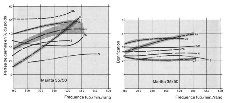
Fig. 4: Rapport existant entre la capacité de plantation (fréquence) et l'endommagement des tubercules pour la sorte Maritta (germes courts et très sujets à la cassure).
