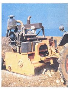
La machine «mange» de gros morceaux, le volume du sol fertile reste intact.
