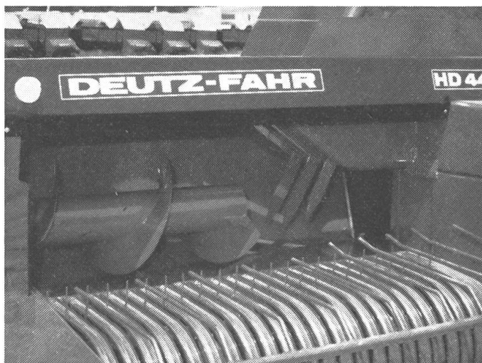
Fig. 2: convoyeur combiné: vis sans fin et ameneur.
