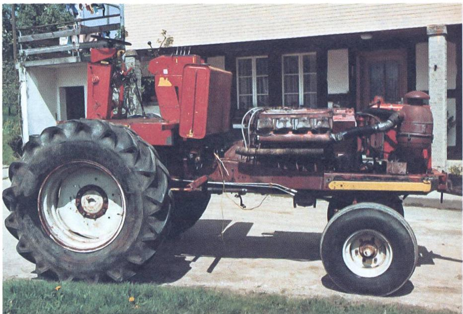
Le chassis et le moteur V8-Deutz (230 CV) proviennent d'une ancienne mélangeuse à béton qui dispose d'une pompe hydraulique telle qu'elle utilisée dans les «mois-batt». (La pompe hydraulique est cachée par le filtre à air.) Leu a en outre fixé sur l'essieu avant la cabine marque Kola et le réservoir à carburant (consommation de diesel env. 50 l/ha). Pour les parties camion, Leu a dépensé env. Fr. 1100.-, pour celles de la «moiss-batt» env. Fr. 1500.-.
