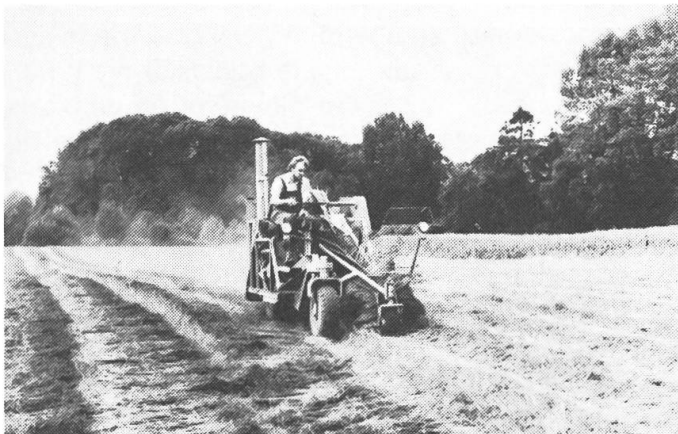
1: Au moyen d'une machine spéciale, le lin déposé en andains est tourné 10 à 14 jours après la récolte. Pendant cette période, le lin a subi le rouissage à terre nécessaire.
