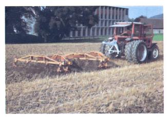
Avec une herse à bêches roulantes de construction lourde, comprenant quatre rangées à bêches montées l'une derrière l'autre, il est possible d'obtenir, sur sols difficiles à travailler, un effet intensif de mélange et d'émottage en un seul passage. Hormis le déchaumage, une mise en œuvre ménageant le sol pour préparer le lit de semences est possible. On obtient, en association avec un rouleau packer, en plus du nivelage du sol, un raffermissement de la surface à grosses mottes.
