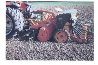
Avec un semoir spécial muni d'une fraise à bandes, il est possible de travailler et de raffermir une bande large de 10 cm en un seul passage, bande dans laquelle est placée la semence de plantes sarclées. La couche protectrice, composée de résidus de plantes diminue la perte de sol et l'élément nutritifs, puis améliore la capacité hydrique ainsi que la portance du sol.
