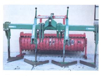
La machine à bêcher à mouvement pendulaire remplace la charrue avec ménagement, par la structure du sol obtenue à grosses mottes de terre et sans semelles à la limite du travail du sol. On peut recommander sa mise en œuvre avant tout sur des sols lourds, «détrempés» et à ornières suite à la récolte de cultures tardives (p. ex. betteraves sucrières). Trad. cs
