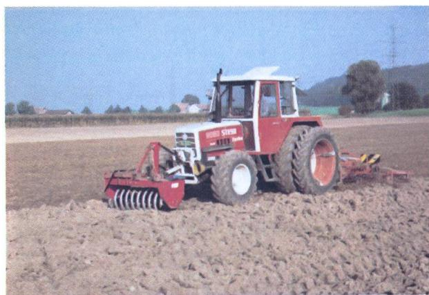
*Selon le type de sol, le labour produit une augmentation du volume du sol d'environ 30–50 %. Un lit de semence trop peu raffermi, c'est souvent le cas lors de la mise en œuvre de combinaisons d'outils, peut entraver un développement régulier des plantes entre les traces de passages. En utilisant un rouleau «tassavant entre les roues» on obtient un répartissement régulier de la pression sur le sol ainsi qu'un lit de semences homogène.*
