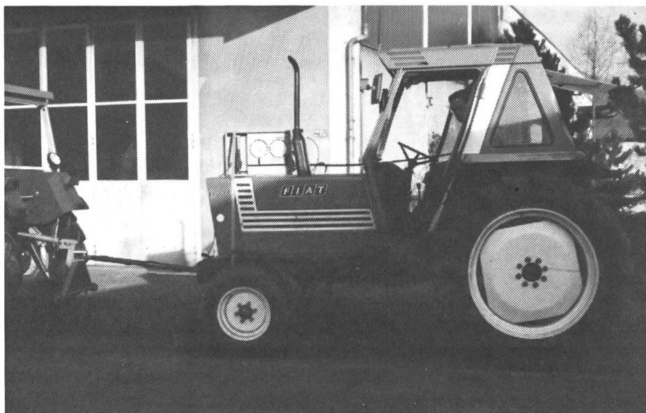
5: Mesure indirecte de la puissance sur le frein du tracteur.
