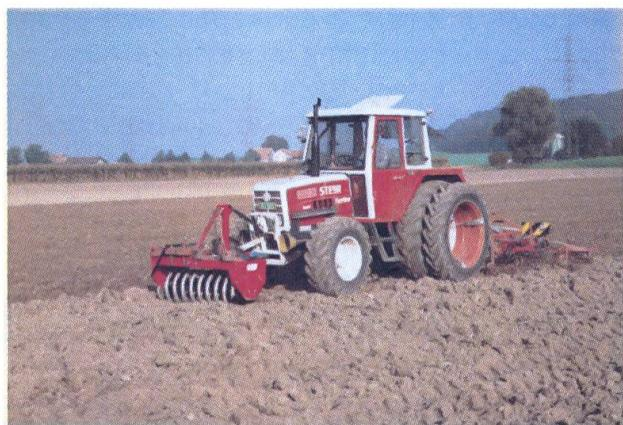
*Selon le type de sol, le labour produit une augmentation du volume du sol d'environ 30 – 50%. Un lit de semence trop peu raffermi, c'est souvent le cas lors de la mise en œuvre de combinaisons d'outils, peut entraver un développement régulier des plantes entre les traces de passages. En utilisant un rouleau «tassavant entre les roues» on obtient un répartissement régulier de la pression sur le sol ainsi qu'un lit de semences homogène.*
