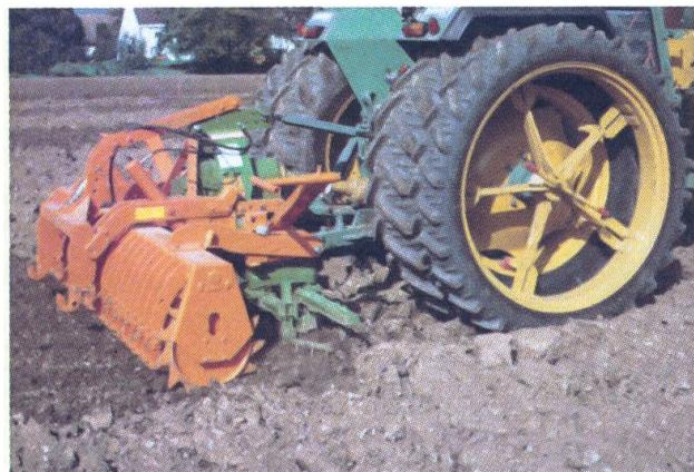
*Avec une herse à bêches roulantes de construction lourde, comprenant quatre rangées à bêches montées l'une derrière l'autre, il est possible d'obtenir, sur sols difficiles à travailler, un effet intensif de mélange et d'émottage en un seul passage. Hormis le déchaumage, une mise en œuvre ménageant le sol pour préparer le lit de semences est possible. On obtient, en association avec un rouleau packer, en plus du nivelage du sol, un raffermissement de la surface à grosses mottes.*
