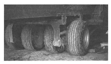
Essieu pendulaire. Selon le stand actuel de la technique, c'est la meilleure solution pour amoindrir la pression sur le sol. La plus grande résistance à la marche des mécanismes de roulement à essieux pendulaires nécessite, en comparaison à l'essieu tandem, une force de traction plus grande.
