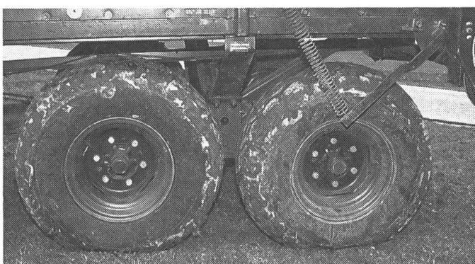
*Essieu tandem. Ce n'est pas une solution optimale, car le sol se compactera même en grandes profondeurs suite à la double utilisation de la même trace. Lors de virages, les roues libèrent des forces latérales importantes qui produisent des dégâts du sol (blessure de la couche herbeuse, lissement du sol) ou une usure élevée des pneus lors de courses sur route.*
