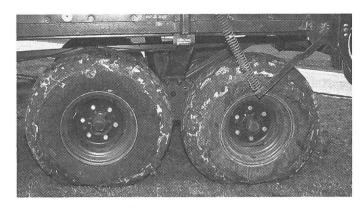
Essieu tandem. Ce n'est pas une solution optimale, car le sol se compactera même en grandes profondeurs suite à la double utilisation de la même trace. Lors de virages, les roues libèrent des forces latérales importantes qui produisent des dégâts du sol (blessure de la couche herbeuse, lissement du sol) ou une usure élevée des pneus lors de courses sur route.
