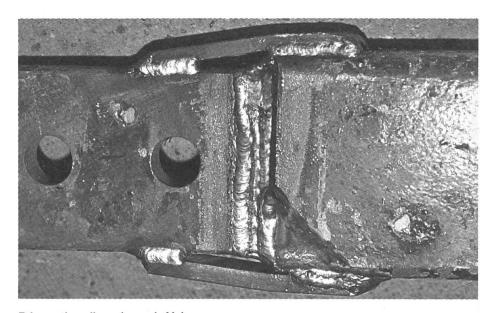
Réparation d'une barre inférieure. Les bords à souder ont été préparés pour une rainure en V. Afin de permettre un travail propre, les deux pièces d'ouvrage ont été fixées latéralement avec 2 fers à profils.
