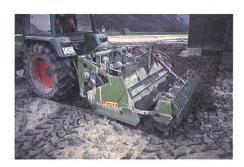
Avec la machine à bêches, la couche de matèrial déposé est mélangée avec le sous-sol.
