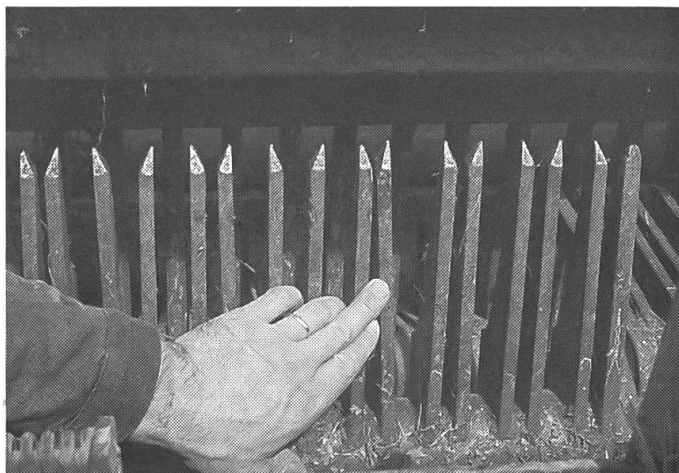
Ces doubles-doigts comprimés endommagent d'une part le couteau de fauchage et produisent des à-coups sur les paliers de l'organe de convoyage.
