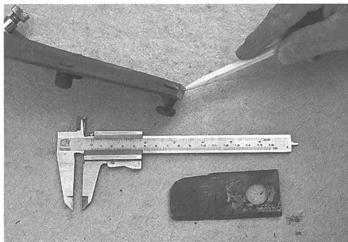
À la place indiquées sur l'image, le bord de l'axe de suspension ne doit pas être usé. Le diamètre de l'axe doit au minimum encore atteindre 8 mm.
