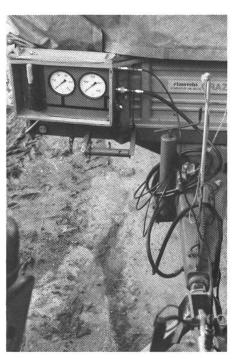
4: Examiner la puissance au frein sur une remorque à un essieu. On reconnaît les deux manomètres et, sur le bord inférieur, l'éprouvette graduée entre le tracteur et la remorque.
