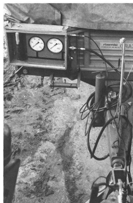
4: Examiner la puissance au frein sur une remorque à un essieu. On reconnaît les deux manomètres et, sur le bord inférieur, l'éprouvette graduée entre le tracteur et la remorque.
