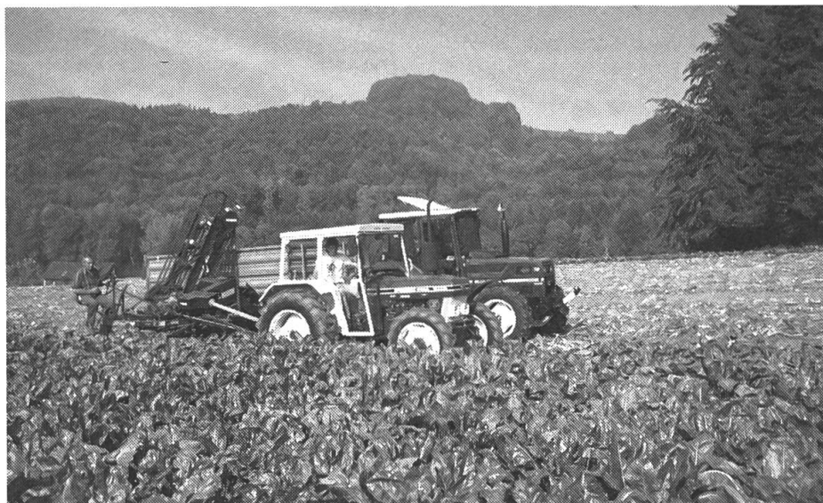
4: Les récolteuses totales plus simples travaillent selon le principe de la surcharge.
