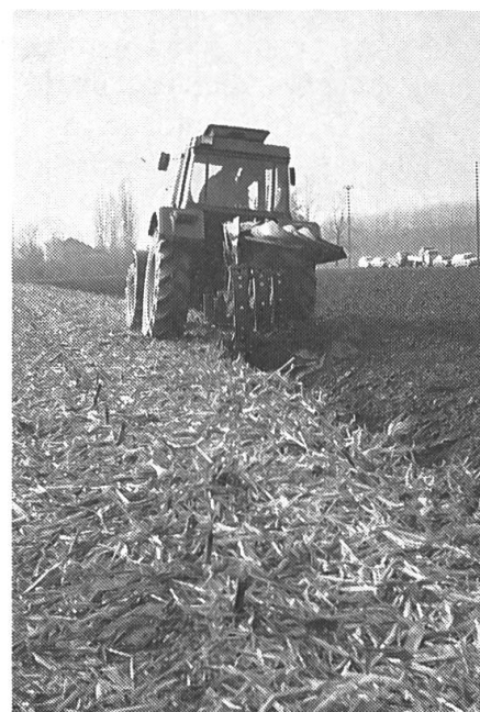
2: Le résultat du retournement du sol de la plupart des charrues était satisfaisant. Suite aux résidus de récolte, ci et là des problèmes d'étranglement.
