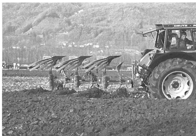
4: Une seule charrue à claire-voie a été présentée. Pas d'avantages sérieux selon les résultats d'essais de la FAT.
