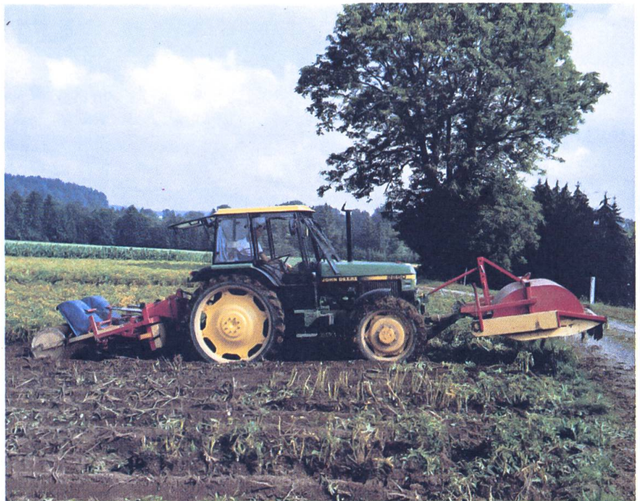
La déchiqueteuse de fanes est fixée à l'avant du tracteur. Les fanes déchiquetées sont déposées entre les rangs. L'expérience a montré que les parties de tiges restantes de dessèchent par la suite et qu'aucune influence négative sur la qualité des semenceaux n'est à craindre.
