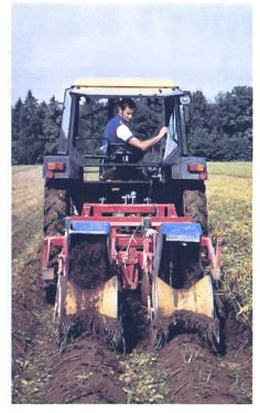
Arracheuse de fanes Oldenhuis dans un champ de semenceaux de pommes de terre. Les fanes sont saisies et arrachées par des soufflets de chaoutchouc situés devant deux rouleaux de pressage se comprimant l'un contre l'autre.
