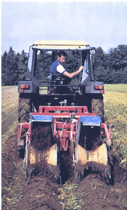
Arracheuse de fanes Oldenhuis dans un champ de semenceaux de pommes de terre. Les fanes sont saisies et arrachées par des soufflets de chaoutchouc situés devant deux rouleaux de pressage se comprimant l'un contre l'autre.
