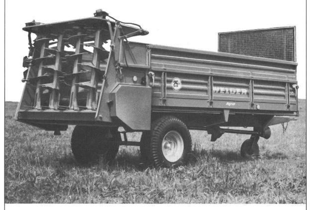
Epandage d'une finesse irréprochable et d'une régularité parfaite avec notre distributeur 4 rouleaux verticaux à colimacon.
