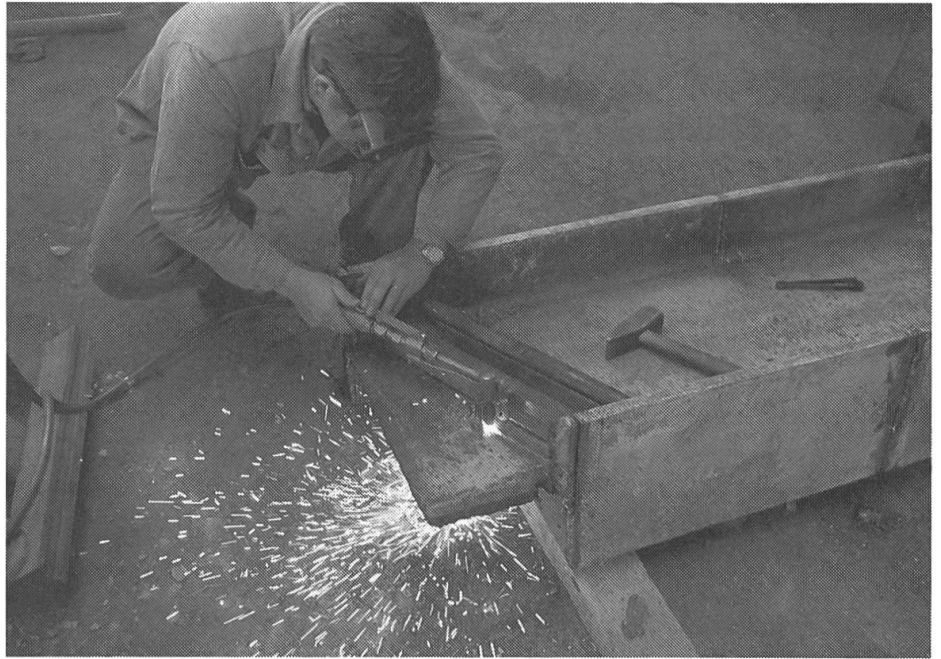
Entre autres utilisations importantes, l'installation de soudage autogène permet de couper de l'acier à la flamme.
