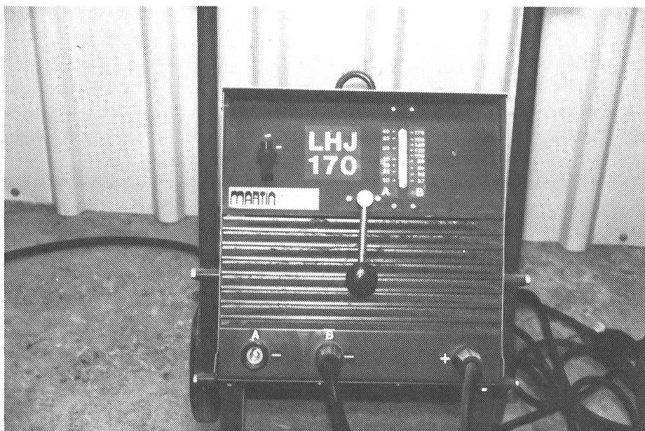
Redresseur à réglage mécanique pour l'agriculture: une durée d'enclenchement jusqu'à environ 180 ampères suffit.
