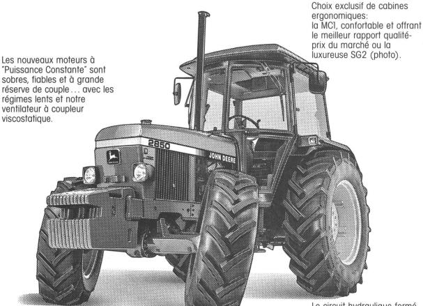
Le pont-avant mécanique, à angle de chasse exclusif de 12° permet de virer sur place, un simple bouton commande l'enclenchement avec un bout de doigt. Le robuste pont-avant est à différentiel autobloquant.
