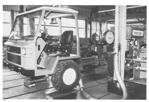
Fig. 1: Le mesurage de la puissance à la prise de force indique la puissance disponible pour la pratique. Les fabricants indiquent en général la puissance du moteur; celle-ci dépasse la puissance à la prise de force d'environ 10%, car ils ne tiennent pas compte des pertes dans la boîte et de celles provenant de la commande de pompes hydrauliques, par exemple.
