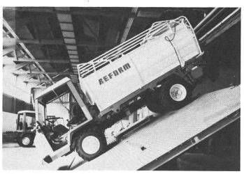
Fig. 4: Mesurage du frein à main. Le frein à main est tiré à raison de 40 daN (kp). Ensuite le véhicule chargé à plein est incliné sur le pont basculant jusqu'à ce qu'il commence à rouler.
