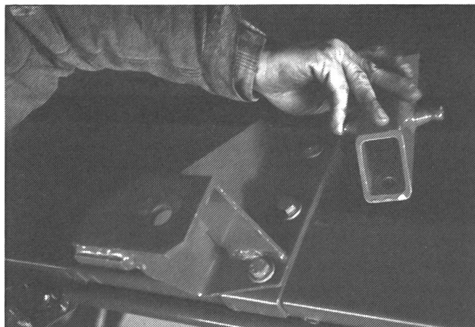
Fig. 6/7: Le système de montage des outils correspond en grande partie aux normes SN. Pour l'attelage d'outils d'autres marques, il ne faut que changer les quatre pièces de raccord à la machine. Ce changement s'opère avec de simples outils.
