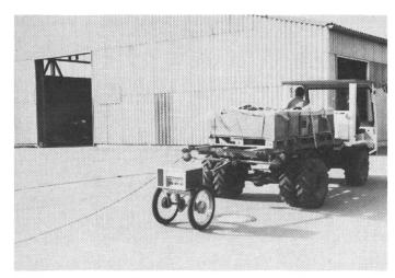
Fig. 3: Mesurage du frein à pied, à charge utile maximale. Pour la moyenne de décélération, nous avons tenu compte de la distance d'arrêt, de la vitesse maximale avant le freinage et de la pression sur la pédale.
