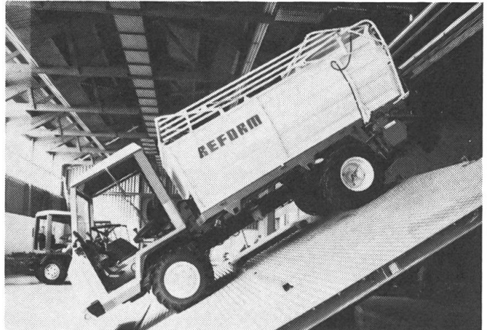
Fig. 4: Mesurage du frein à main. Le frein à main est tiré à raison de 40 daN (kp). Ensuite le véhicule chargé à plein est incliné sur le pont basculant jusqu'à ce qu'il commence à rouler.
