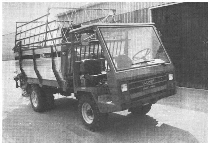
Fig. 6/7: Le système de montage des outils correspond en grande partie aux normes SN. Pour l'attelage d'outils d'autres marques, il ne faut que changer les quatre pièces de raccord à la machine. Ce changement s'opère avec de simples outils.
