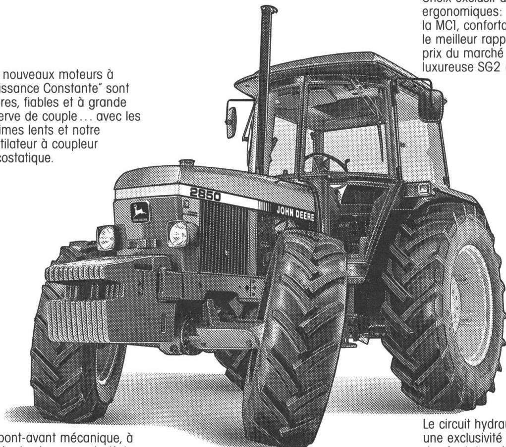
Le pont-avant mécanique, à angle de chasse exclusif de 12° permet de virer sur place, un simple bouton commande l'enclenchement avec un bout de doigt. Le robuste pont-avant est à différentiel autobloquant.
