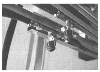
Fig. 7: Les buses interchangeables et à raccord rapide par baïonnette et angle d'incidence fixe font en général partie de l'équipement standard.
