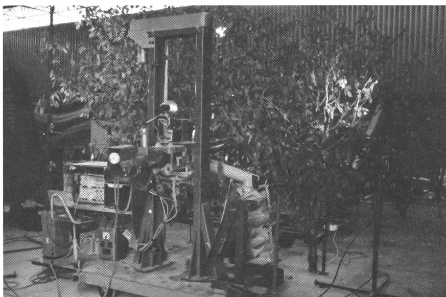
Prototype du robot pour la cueillette des pommes développé en France.
