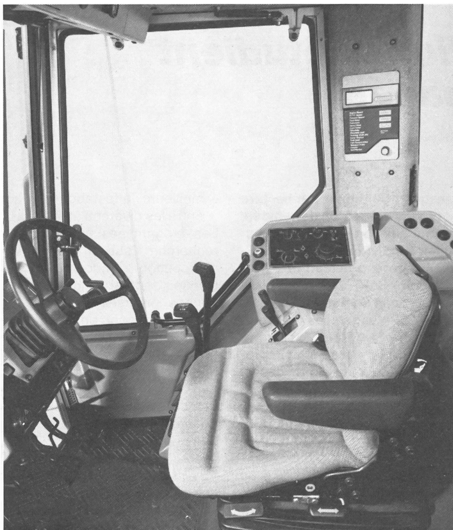
La console «datatronic» se trouve à droite du conducteur. La CERH se trouve à portée de main. Le confort du conducteur est amélioré par la disposition ergonomique des pédales, par un siège entièrement pivotant et réglable et par un volant télescopique réglable en inclinaison.
