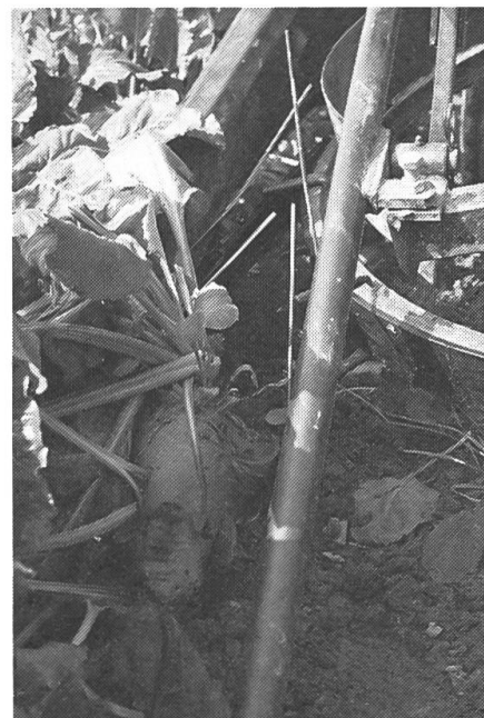
Système spécial pour arracher les betteraves fourragères: Les betteraves sont arrachées par les feuilles au moyen de deux bandes de caoutchouc.
