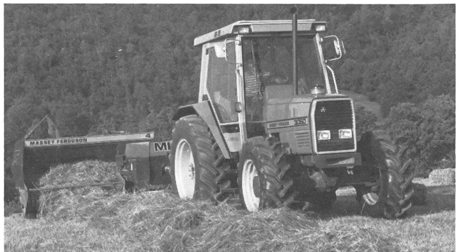
Le tracteur MF 3050 «autotronic» (68 CV-DIN) et 50 kW est équipé en série d'une boîte de vitesses entièrement synchronisée, d'une commande électronique du système hydraulique et d'une cabine confort avec un niveau de son d'environ 75 dB (A).
