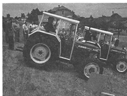
2: L'avantage d'un tracteur «4 roues motrices» est bien visible! Alors que le tracteur de gauche à commande «4 roues motrices» enclenchée arrive à monter cette pente sans problèmes, l'autre tracteur, à pneus identiques, mais sans entraînement toutes roues motrices, patine très vite.
