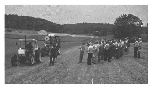
1: Mesurer le patinage sur champs. – Malgré un sol absolument sec, on a pu constater de grandes différences de glissement selon les pneumatiques.
