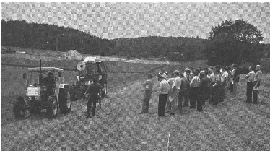
1: Mesurer le patinage sur champs. – Malgré un sol absolument sec, on a pu constater de grandes différences de glissement selon les pneumatiques.
