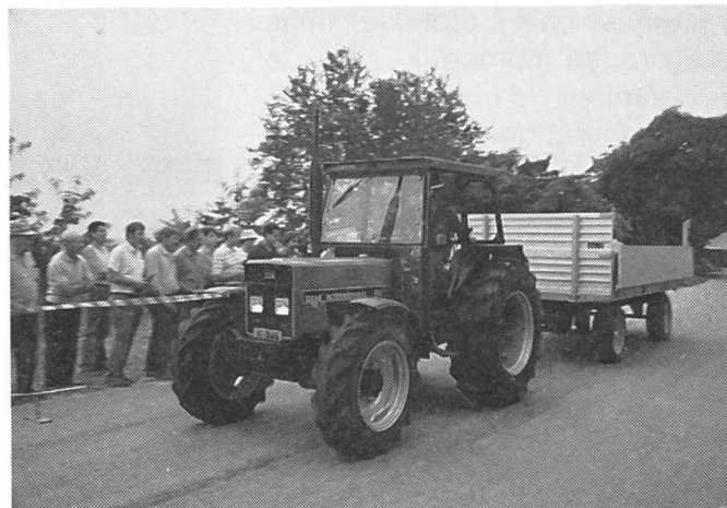
4: Ses explications ont été suivies d'une démonstration impressionnante de freinage. Voilà: freinage à bloc sans commande «4 roues motrices».
