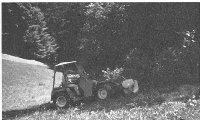
2: Tailler des buissons avec une faucheuse à fléaux – sans problèmes grâce à la puissance augmentée.
