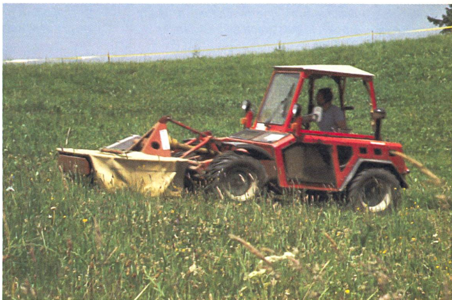
1: Le TT88 utilisé comme faucheuse à deux essieux avec faucheuse à rotors.
