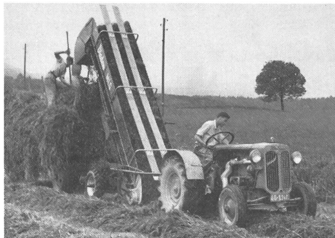
5: Ramasseuse-chargeuse avec prolongation de l'élévateur.
