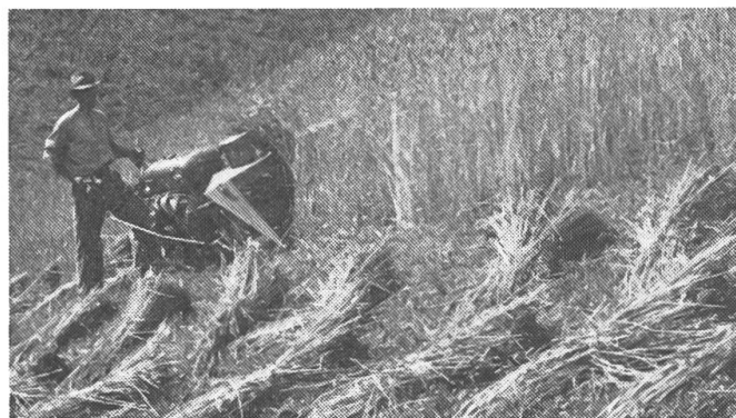
8: Lieuse frontale guidée par une roue-support et adaptée au tracteur monoaxe.
