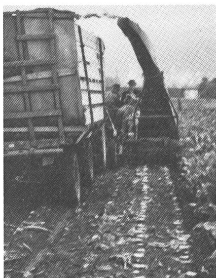
15: Récolte des feuilles avec une récolteuse-hacheuse à fléaux simples.
