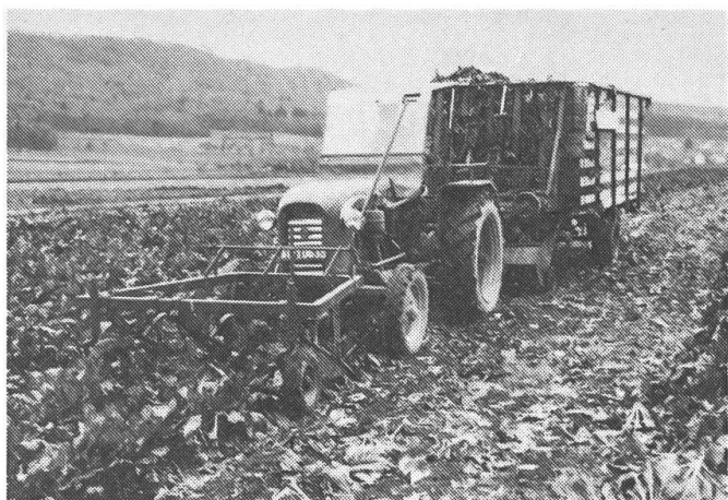
13: Récolte des feuilles avec une décolleteuse frontale et une remorque autochargeuse.
