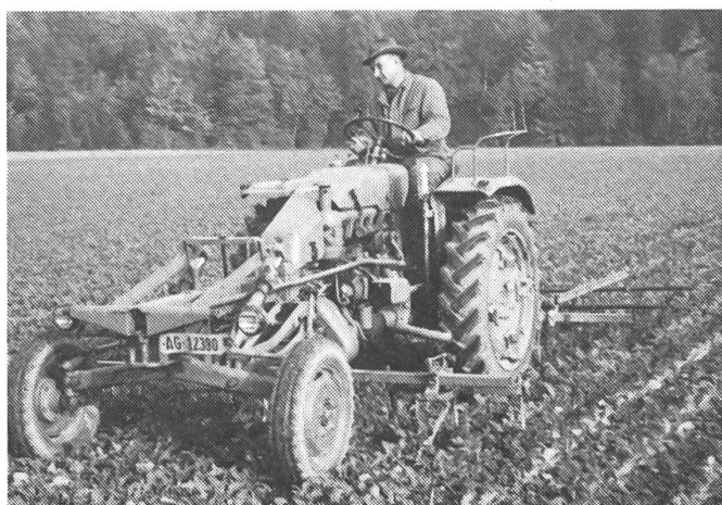
4: «Porte-outils» avec attelage sous le tracteur et appareil tiré.
