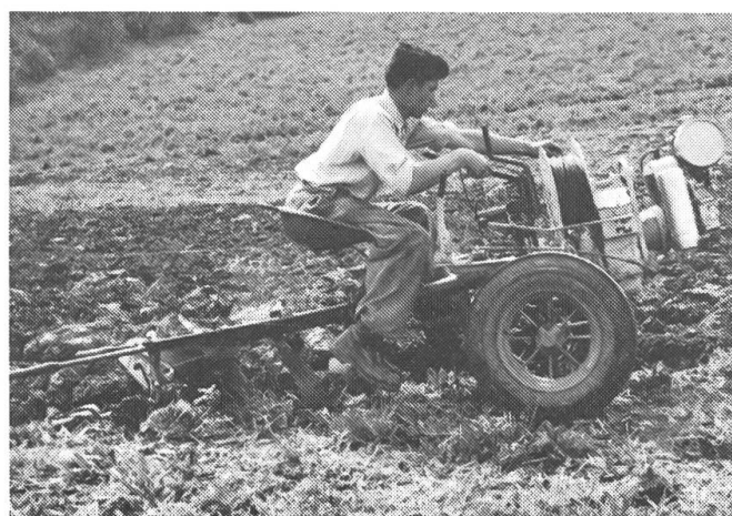
5: Les efforts durant plusieurs années pour simplifier la culture en pentes ont mené à des solutions adéquates, comme par exemple le procédé de traction par câble au moyen d'un treuil.
