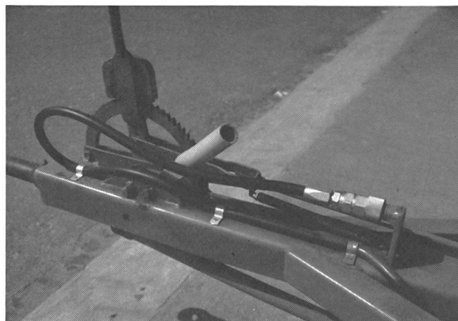
La conduite de freinage sera montée sur une pièce aveugle lorsque la remorque est arrêtée (danger de pollution!)
