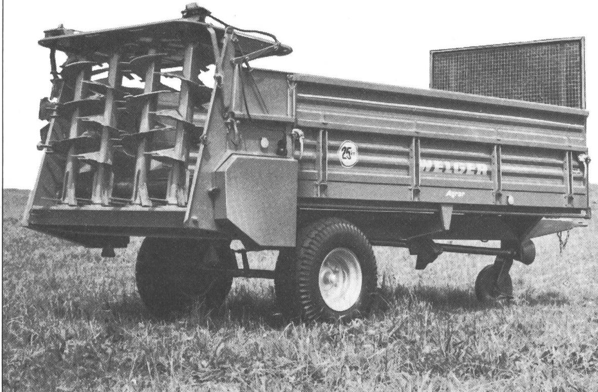
Epandage d'une finesse irréprochable et d'une régularité parfaite avec notre distributeur 4 rouleaux verticaux à colimaçon.
