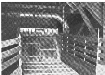
Fig. 3: Le doseur prend en charge le travail de l'alimentation de la souffleuse, et la remorque auto-chargeuse est également à nouveau libre après vidage rapide. Cependant, une aide devrait surveiller les machines pour des raisons de sécurité (prévention des accidents).
