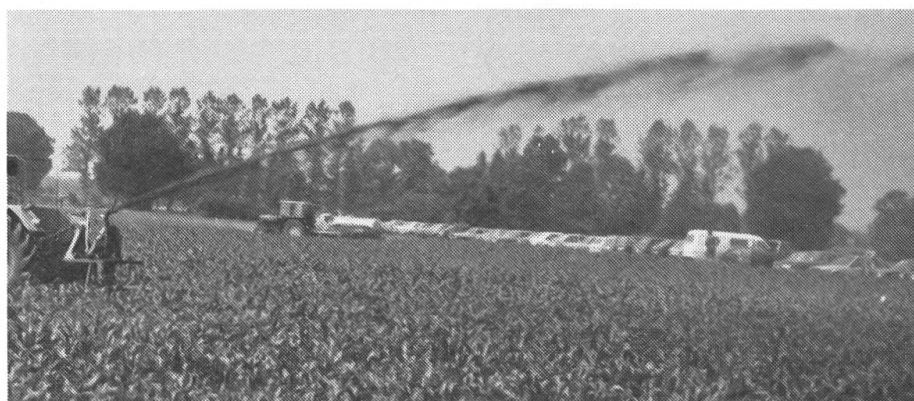
7. Sur le maïs en croissance, le lisier peut être épandu avec un épandeur de lisier à trois points. Le jet doit être élevé pour éviter que les plantes de maïs ne cassent pas.
