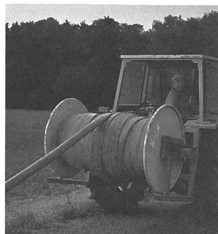
6: Les nouveaux tuyaux spéciaux en PVC à haute pression s'enroulent sur un tambour moins grand. Leur poids est moindre que celui des tubes en polyéthylène. Ils risquent toutefois de s'entortiller.
