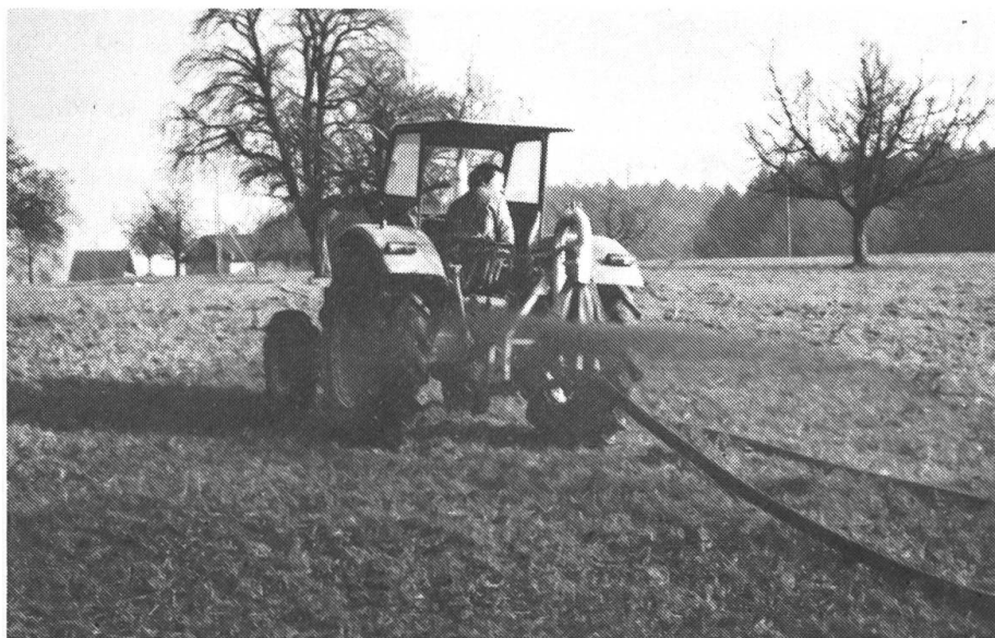
5: L'épandeur de lisier «JOVO», avec le déflecteur, garantit un bon épandage du lisier. Il est construit de façon simple, le prix d'achat est modeste. La largeur de travail s'élève à 8 – 9 m.
