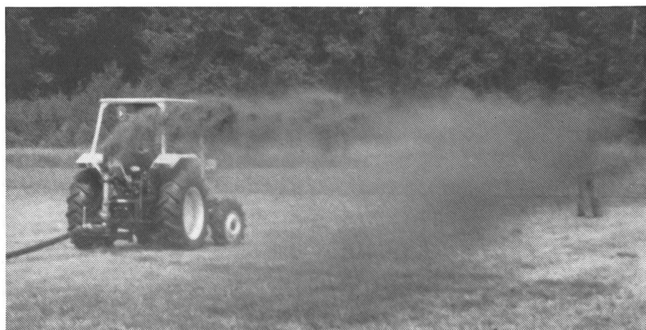
3: Les épandeurs de lisier automatiques doivent être réglés le mieux possible. Le jet de lisier devrait être dirigé vers le haut. Les lanceurs gicleront régulièrement des deux côtés.
