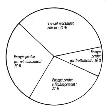
Répartition de l'énergie du carburant transformée dans un moteur Diesel à admission naturelle. Ce «bilan thermique» d'un moteur fait apparaître des pertes supérieures aux deux tiers de l'énergie fournie.
