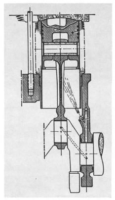
Système de refroidissement de piston par gicleur d'huile alimenté par le circuit de lubrification des paliers de vilebrequin. (CEMAGREF).
