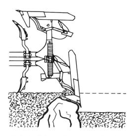
A choix: Déclenchement par boulons de rupture sur chaque corps, semiautomatique, ou Non-stop
