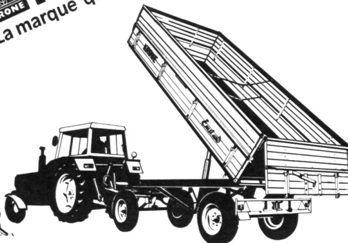
Remorques basculantes 3-côtés, à 2 essieux, avec ridelles en Alu éloxé.
