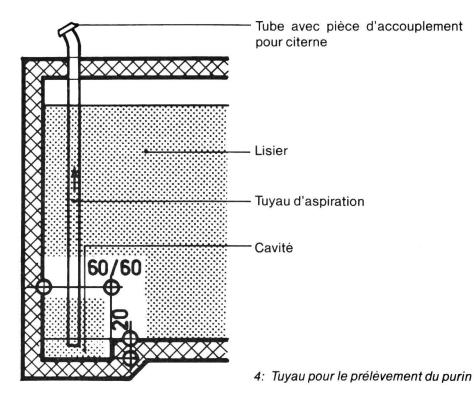
Afin que les gaz de lisier ne provoquent pas d'accident, il est recommandé de construire des ouvertures d'aération (p.ex. couvercles à trous) ainsi que des fermetures du côté étable (p.ex. syphon).
