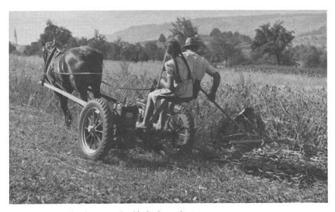
4: Mécanisme à rabat pour le dépôt de petits tas.
