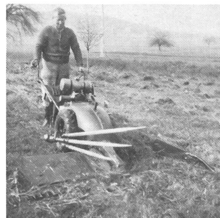
10: Une fourche en bois entraînée par un moyeu constituait le premier mécanisme de récolte de l'herbe.
