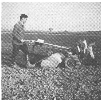
8: Les premiers tracteurs monoaxe furent développés à partir des fraiseuses agricoles.
