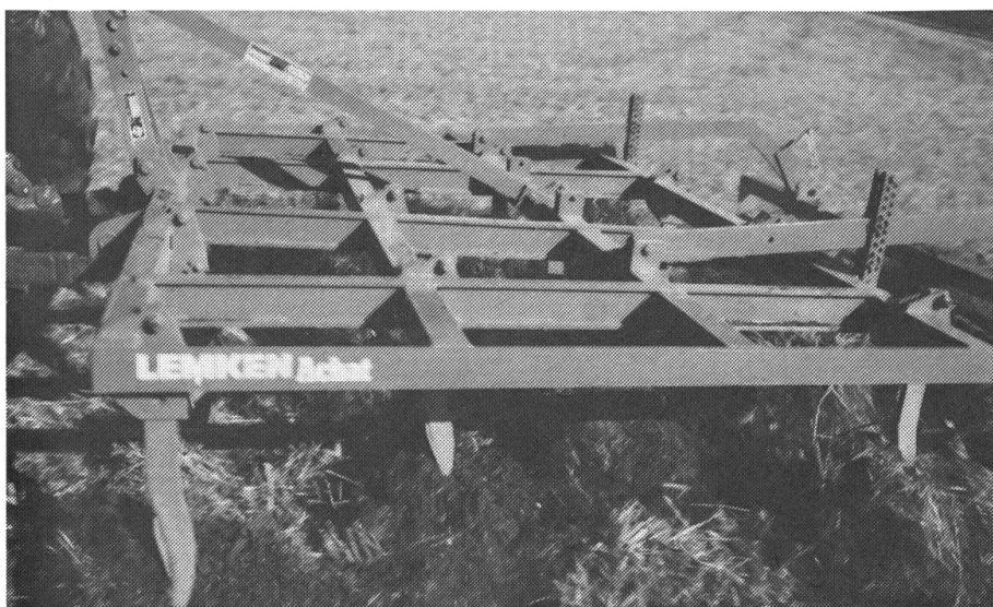
Les cultivateurs rasette à 2 ou 3 barres atteignent un rendement de travail optimal par une vitesse d'avancement de 8 à 10 km/h. Ils enfouissent la presque totalité de la paille.
