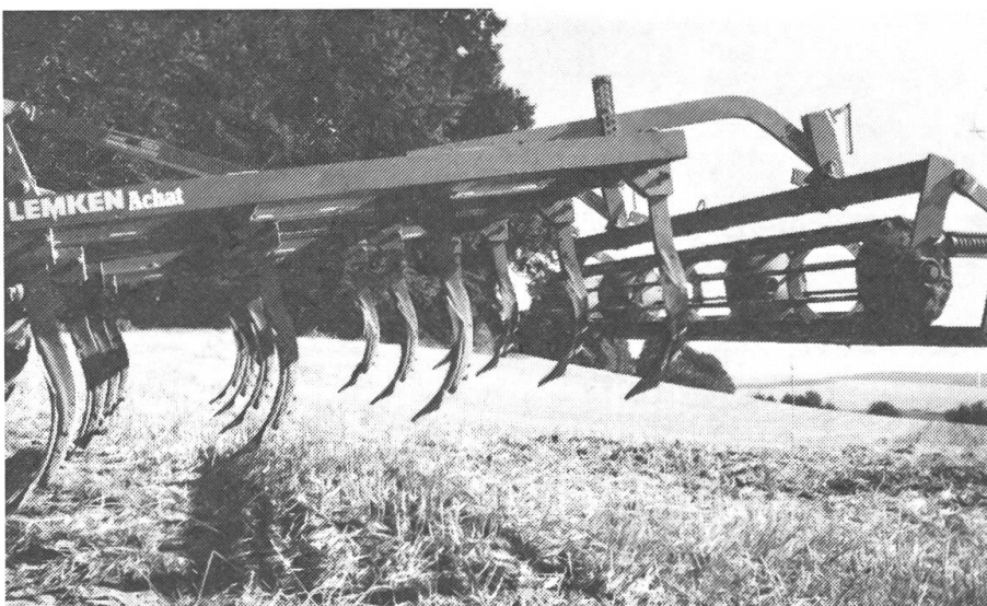
Trois fautes principales: distribution inégale de la paille, des chaumes trop élevés et une longueur de hachage trop importante. Le travail en souffre même s'il est effectué avec de bons outils.
