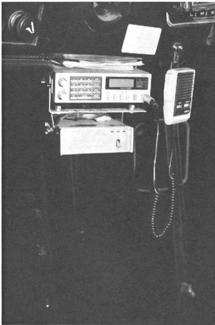
Station mobile installée à demeure sur une ensileuse automotrice à maïs. Une bonne isolation acoustique de la cabine est la condition première pour pouvoir entrer en contact avec le conducteur durant le travail.
