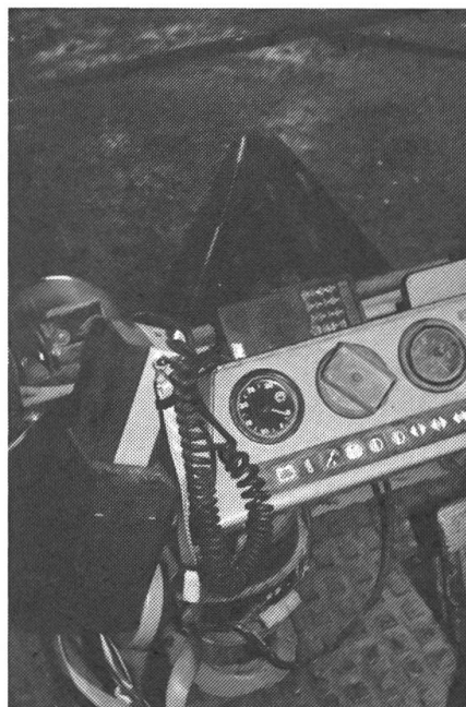
Poste de radiocommunication portatif installé sur un Deutz-Intrac. Avec cet appareil, on ne peut guère émettre durant la course. Fritz Hirter l'utilise surtout pour la récolte du maïs. Grâce à cette liaison, l'homme qui travaille dans le silo peut communiquer directement avec le conducteur et lui indiquer quelle quantité il lui faut encore pour remplir le silo.
