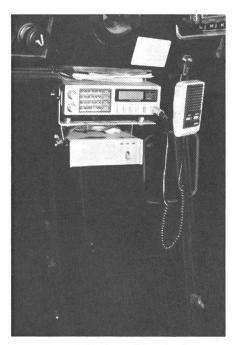
Station mobile installée à demeure sur une ensileuse automotrice à maïs. Une bonne isolation accoustique de la cabine est la condition première pour pouvoir entrer en contact avec le conducteur durant le travail.
