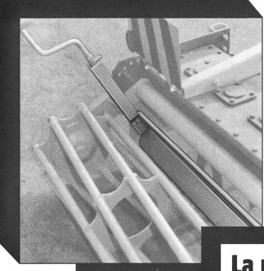
La planche niveleuse réglable de la herse rotative VLG ne laisse passer aucune motte.
