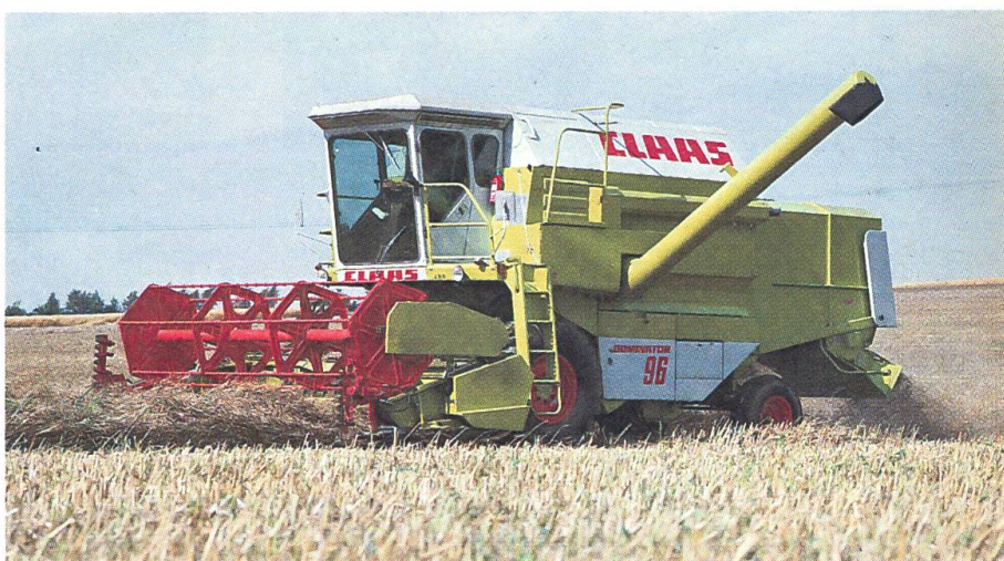
Les pertes sont particulièrement grandes lorsque les cosse sont déchirés lors de la séparation. Avec un couteau diviseur sur le côté droit, on peut réduire de beaucoup ces pertes. (Photo Claas)
