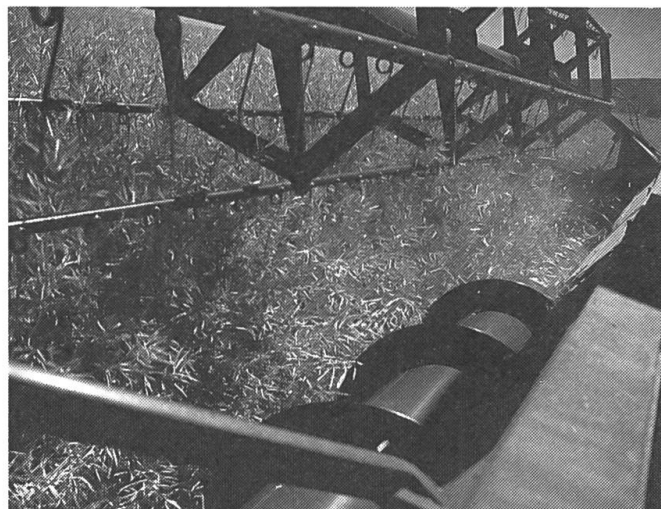
Une prolongation suffisante est importante afin que la récolte passe, même en peuplements lourds, sans engorgement sous la vis d'alimentation. (Photo Krebs)
