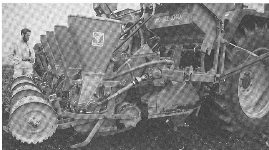
2: Derrière le cultivateur, un rouleau tasse le sol meuble puis on y dépose la semence.
