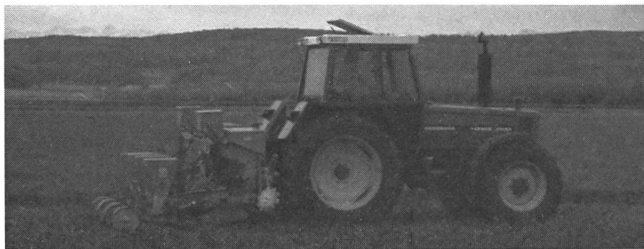
1: Le poids d'un cultivateur rotatif à 4 rangs exige un tracteur d'au moins 70 CV.
