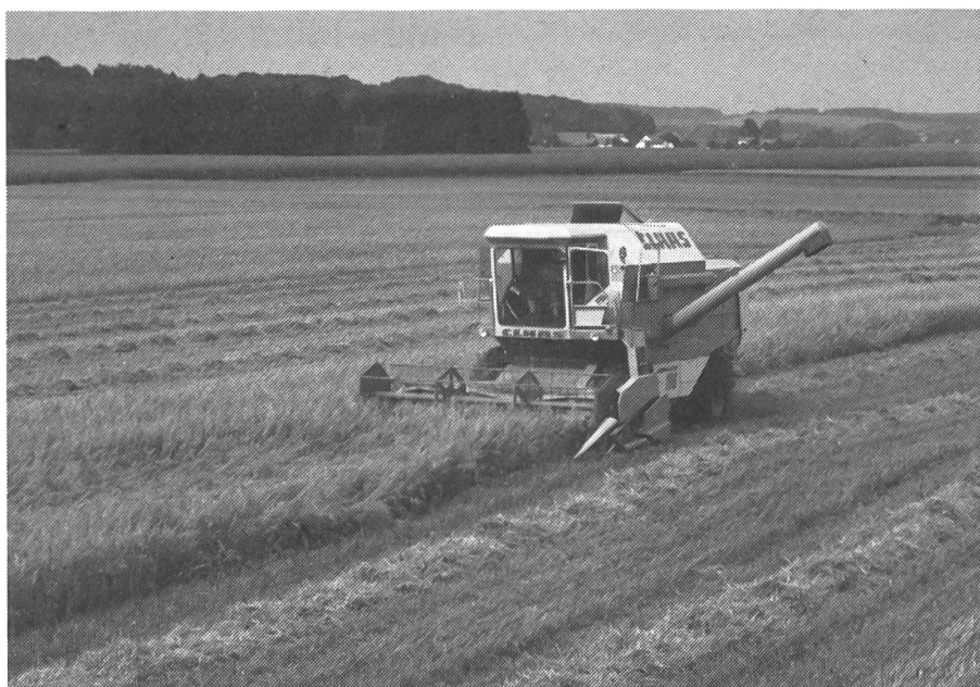
En présence de céréales versées, les pertes de récolte peuvent être réduites grâce à un pilotage précis de la barre de coupe.
