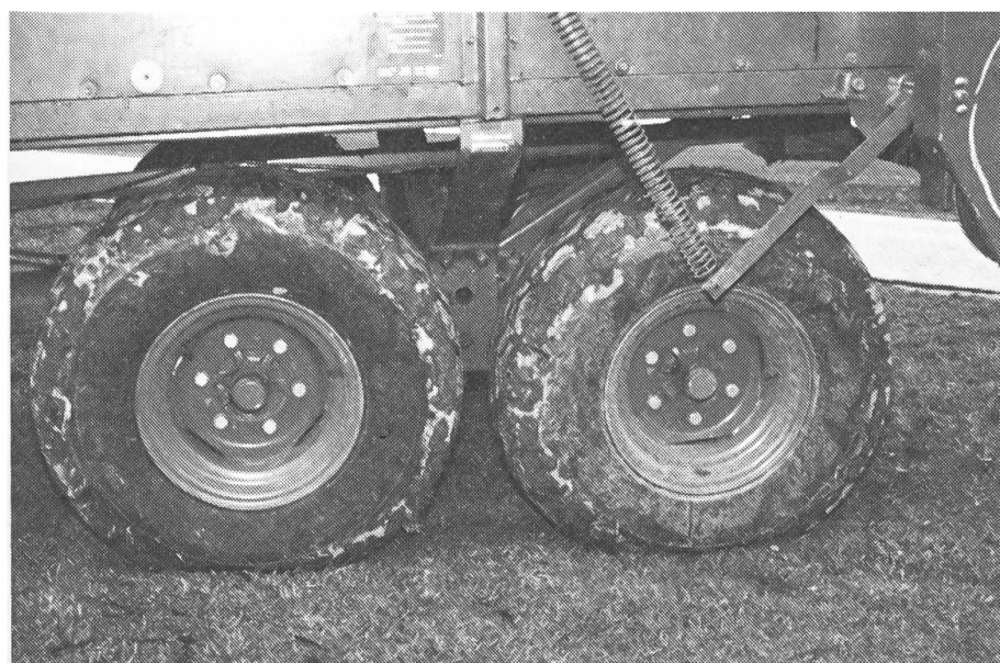
Attention à la pression sur le sol! Il faut adapter le montage des pneus à la capacité des épandeurs.
