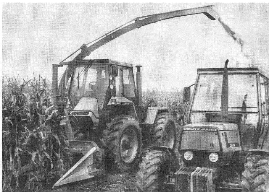
Le siège au front, le nouveau tracteur d'Intrac offre une bonne vue sur les outils de front et ne nécessite pas de dispositif coûteux à marche arrière.
