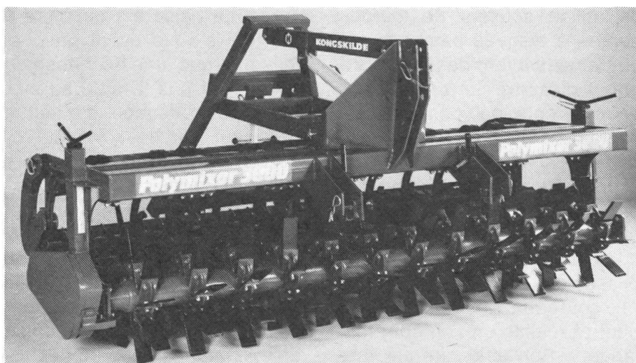
Cet outil pour le travail des chaumes est une combinaison de dents d'ameublissement suspendues et des vis à bêche et à couteaux.
